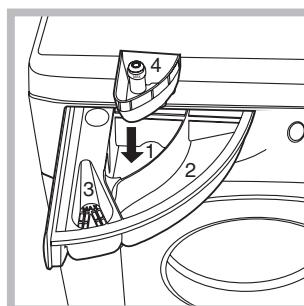
Для осуществления только отбеливания поместите отбеливатель в дополнительный дозатор 4 и задайте программу «Полоскание» и включите функцию «Отбеливание». Для отбеливания в процессе стирки засыпьте стиральный порошок и добавки, задайте нужную
