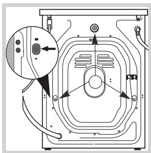
3. Снимите 3 транспортировочных болта, предохраняющие машину в процессе перевозки, и резиновую заглушку с соответствующей распорной шайбой, расположенные в задней части стиральной машины (см. схему).
