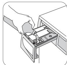
Вытяните до упора дозатор моющих средств. Отмерьте нужное количество моющего средства, засыпьте его в отделение основной стирки дозатора и, если Вы желаете выполнить предварительную стирку или вымачивание, засыпьте его в отделение, помеченное символом . При наличии такой необходимости насыпьте смягчитель тканей в отделение дозатора, помеченное символом (не превышая отметку "MAX"). Осторожно закройте дозатор моющих средств.
