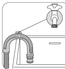
Подвесить над краем раковины, используя пластмассовую направляющую, входящую в комплект поставки
