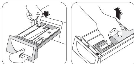
Aby čištění bylo snazší, lze vrchní díl komory na přísady vyjmout.
