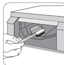
Po vyjmutí zásuvky použijte malý kartáček na čištění prostoru na zásuvku tak, abyste z vrchních i spodních částí prostoru odstranili všechny usazeniny pracího prášku.
