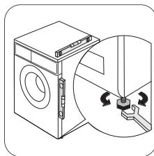
Podle potřeby zkontrolujte správné vyrovnání pomocí vodováhy.
