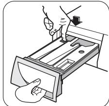
Извлеките дозатор, отжав вниз защелку и потянув его на себя. Промойте его под краем, чтобы удалить все остатки скопившегося в нем порошка.
