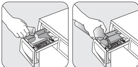
Вытяните до упора дозатор моющих средств. Отмерьте необходимое количество моющего средства, поместите его в отделение дозатора, предназначенное для основной стирки (Ш) или в соответствующее отделение, если этого требует выбранная программа/дополнительная функция (более подробную информацию см. в разделе "Дозатор моющих средств").
