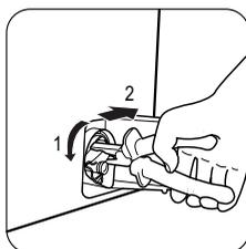
Когда вода перестанет литься, открутите крышку фильтра и с помощью плоскогубцев извлеките фильтр. Всегда держите под рукой тряпку, чтобы вытереть воду, которая может пролиться при снятии фильтра.
