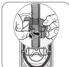
Отсоедините сетевой шнур и шланги от разъемов на задней панели стиральной машины.
