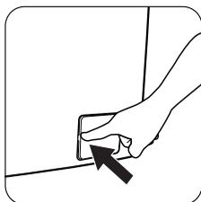
Закройте дверцу фильтра сливного насоса.
