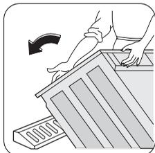
После снятия всей упаковки положите машину на заднюю панель, чтобы вынуть полистироловую прокладку из ее основания.
