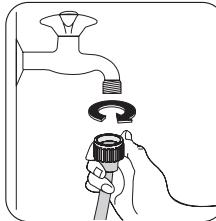
Присоедините наливной шланг к водопроводному крану с резьбой 3/4". Всегда используйте шланг, состоящий из соединенных между собой стиральной машиной.
